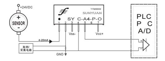
此电路应用在两线制输入回路信号多路采集并有共地问题的检测回路中,只要把 4-20mA 回路从上端断开加入 SY C-A-P-O 就可以实现信号的采集。外接正负电源供电,信号为电压输出方式。
