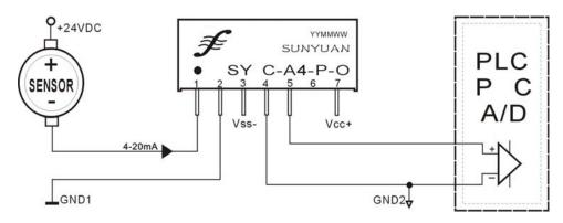
此应用电路实现了两线制仪器仪表输出 4-20mA 信号的 I/V 转换。外接正负电源供电,信号为电压输出方式。
