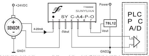
此应用电路是四线制仪器仪表输出的 4-20mA 信号 I/V 变换。电路采样端单电源供电方式,并输入到 A/D 采样。
