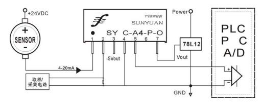
此电路应用在两线制输入信号多路采集并且有共地问题的检测回路中,只要把 4-20mA 回路从上端断开加入 SY C-A-P-O 就可以实现信号的采集。电路采用单电源供电,可输出一个-5V/2mA 电源,方便用户增加一些偏置电路。
