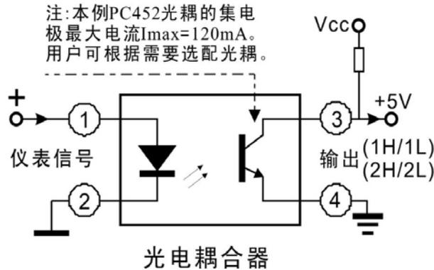
4、由于光敏三极管  $I_c$  最大电流的限制，其扩流和驱动负载能力有限，用户如需更大驱动电流，用来现场驱动继电器、电磁阀、步进电机等装置，可自行外接功率扩展电路（功率放大管或伺服电路）进行扩流放大处理或做特殊定制。
